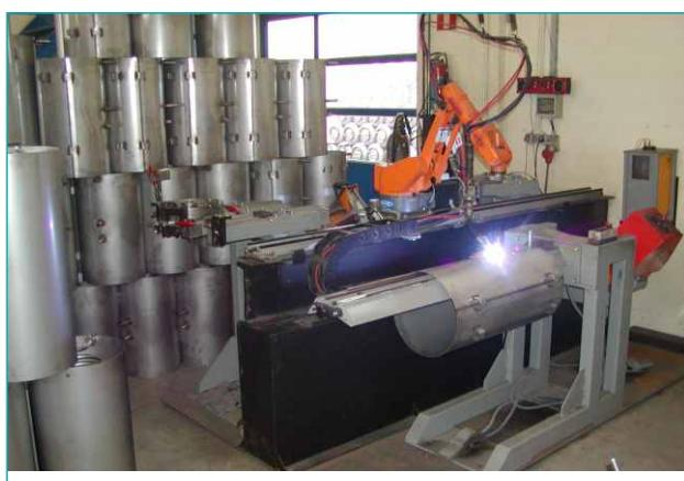
Robotické svařování kotlů z nerezové oceli
