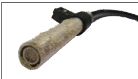
Znečištěná fotobuňka, která může způsobit chybu zapalování nebo plamen, zmizí
