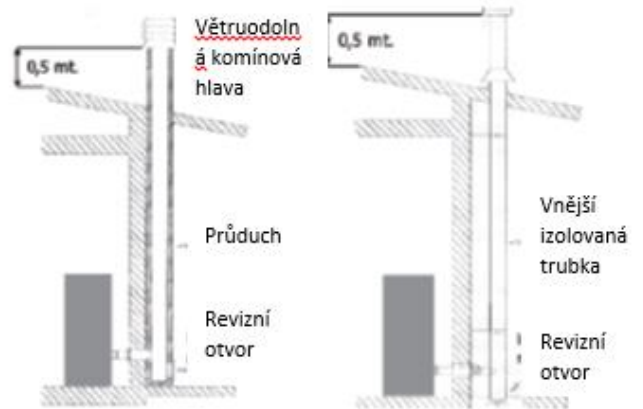
Obr. 2: Spojení s průduchu.
