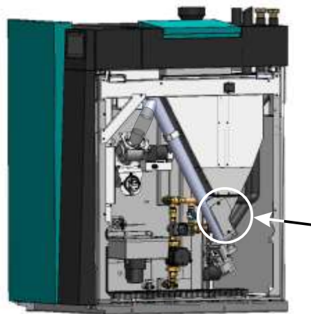
4. Nasadte kryt zpět na boční stranu zásobníku na pelety a bezpečně jej upevněte.
