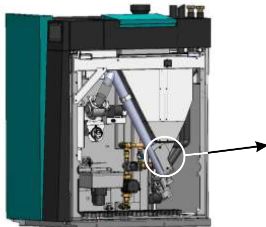
2. Odšroubujte 2 šrouby a otevřete boční čistící víko zásobníku na pelety.
