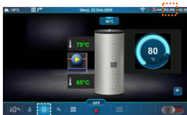
Obrazovka akumulární nádrže (PC-PE)
